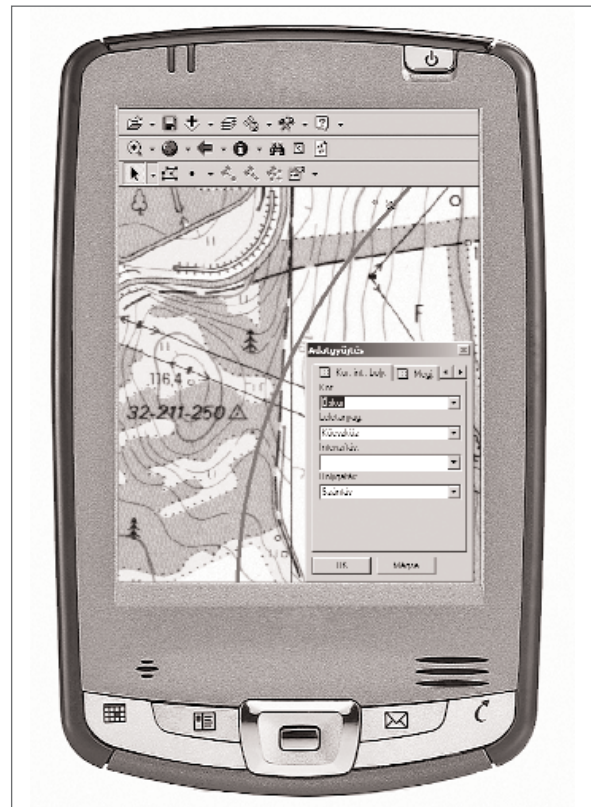
2. kép: Terepi adatrögzítés belső GPS-vevővel ellátott kézi számítógépen
